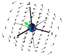
Figura 12: El rotor de un campo (en verde).
